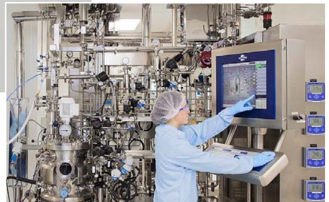
Upstream processing am National Institute for Bioprocessing Research & Training (NIBRT) in Dublin mit einem völlig gesteuerten 150 Liter Perfusions-Bioreaktor. (Bild: NIBRT)
